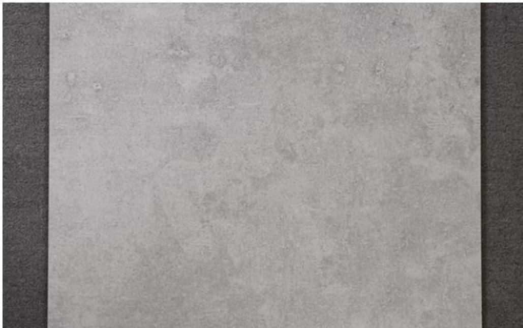
白水泥和灰水泥的成份差的很多的，水泥由熟料(70~95%)、石膏(3~5%)、混合材组成(5~25%)。首先是熟料，水泥的主要组分，由硅酸三钙、硅酸二钙、铝酸三钙和铁铝酸四钙组成。灰水泥中，包含这四个组分，白水泥中，没有或只有极少的铁铝酸四钙，就是这铁元素，使得水泥颜色发灰。然后是混合材，灰水泥用的混合材一般为粉煤灰、矿渣、石灰石粉等，颜色均为灰
