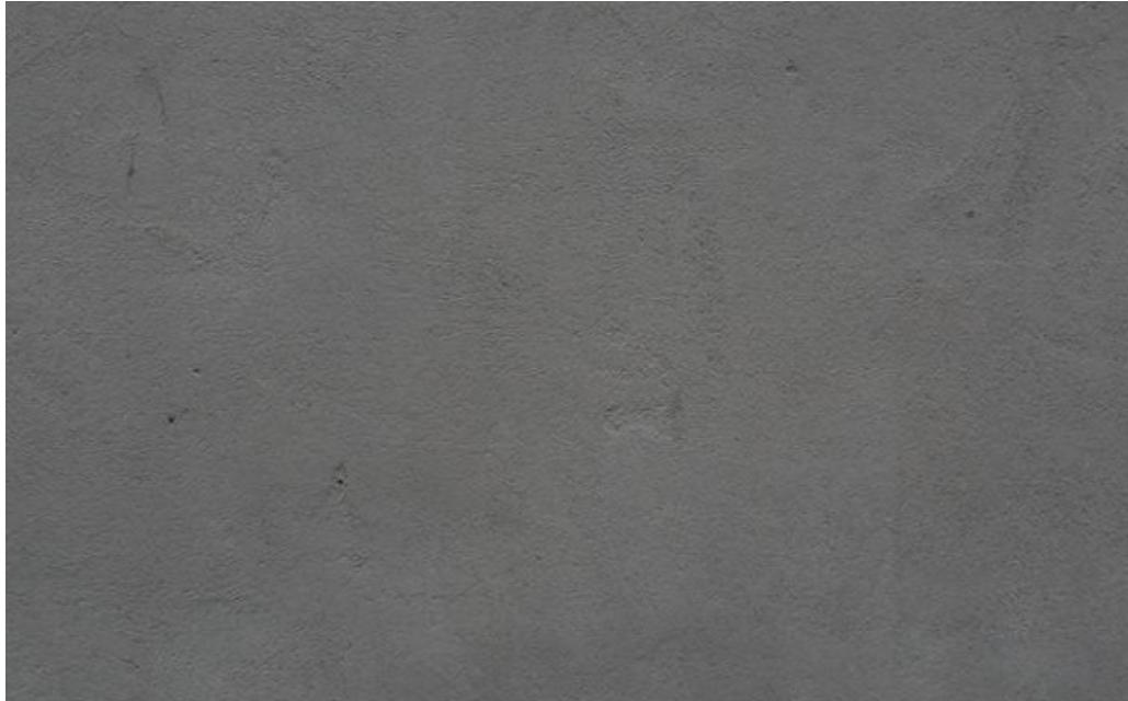
水泥主要原材料：含碳酸钙的岩石含硅酸盐的岩石富含铝和铁的矿石制作：为了水泥的神奇功效，必须要断开碳酸钙和硅酸盐的化学键。但是这些化学键非常稳定，所以要通过高达1450°C的温度（森林大火通常是600°C到800°C）加热让它们断裂。在高温下岩石分裂重组，产生了一群名为硅酸钙家族的物质。降温后形成灰末。（在网上找了张照片，如下图）如果用手去摸，会觉得干痒。这个就是水泥了。水泥+水的化学反应这些水泥粉末加水后会迅速把水吸收，然后颜色变深，变成半固体的凝胶状（如下图）。水泥加水胶化主要是得益于水合硅酸钙原纤维（以下简称原纤维）。原纤维的形成：水泥加水之后，钙和硅酸分子溶解，形成极似有机分子的晶体结构（见下图），并且不断生长，增生的原纤维会彼此交错，形成键结锁住更多水分，直到水泥从凝胶变为坚硬的固体为止。
